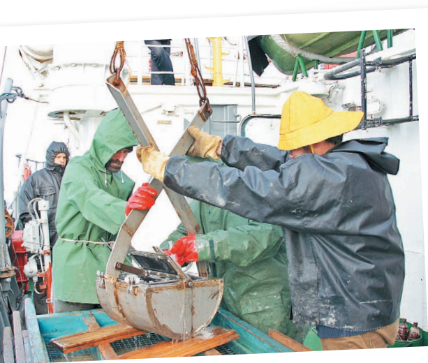
Работа с дночерпателем, отбор проб.
